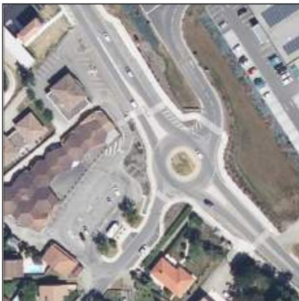
Le giratoire possède une ergonomie évasée qui favorise les vitesses en son sein. Les véhicules observés sont en capacité d'accélérer en sortie. Ce phénomène est accentué par la présence des deux arrêts de bus ce qui permet aux véhicules d'avoir une trajectoire rectiligne.
